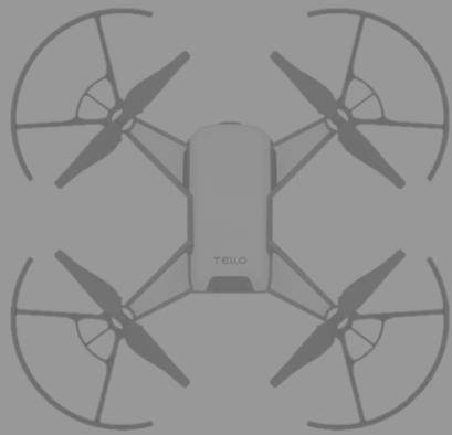
ドローン本体はWi-Fiの電波で操縦&カメラ映像が送信される
